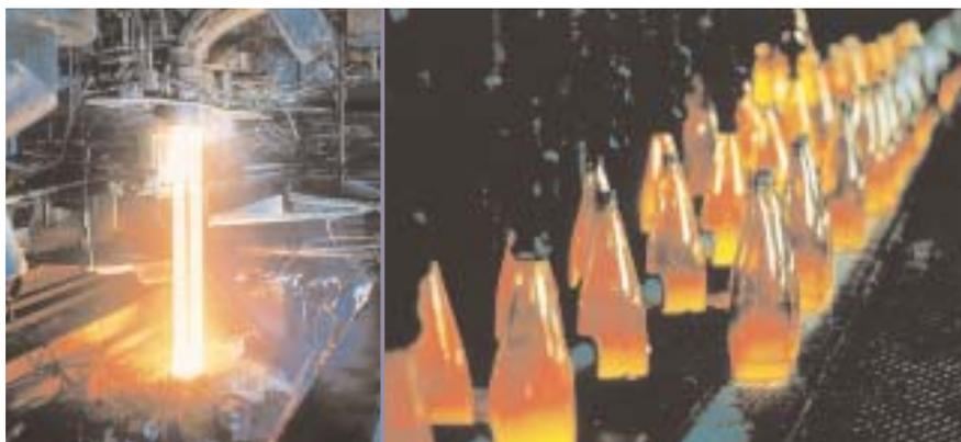
**Remplissage de moules de bouteilles avec du verre fondu**
